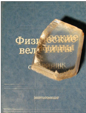
Рис. 19.1. Двойное лучепреломление в кристалле кальцита
